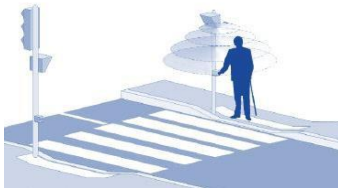
Рисунок 10 – Примеры размещения направленности действия технических средств звуковой сигнализации на регулируемых пешеходных переходах
